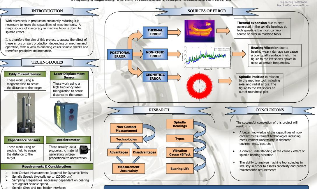
PROJECT AIM: TO INCREASE SPINDLE ANALYSIS EFFICIENCY AND ACCURACY
